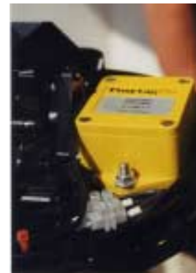
Einkanaldatenlogger „Zähler“ auf der Grundplatte eines automatischen Regenmessers Davis
